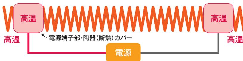
新発熱体を利用した「シリコンラインヒーター」は15m以上の距離でも1つの電源で均一温度を発する発熱体です。シリコン被膜で絶縁されており耐水性にも優れています。
